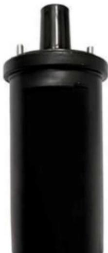
La bobina do botella, es un dispositivo de inducción electromagnética o inductor, que es parte del encendido del motor de combustión interna y su función es elevar el voltaje normal de la batería (6, 12 o 24 V, según el caso).
